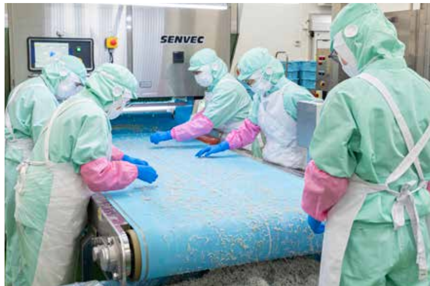
しらす以外の異物は、センサーを使って風圧で飛ばし、さらに目視と手作業でも取り除く徹底ぶり
